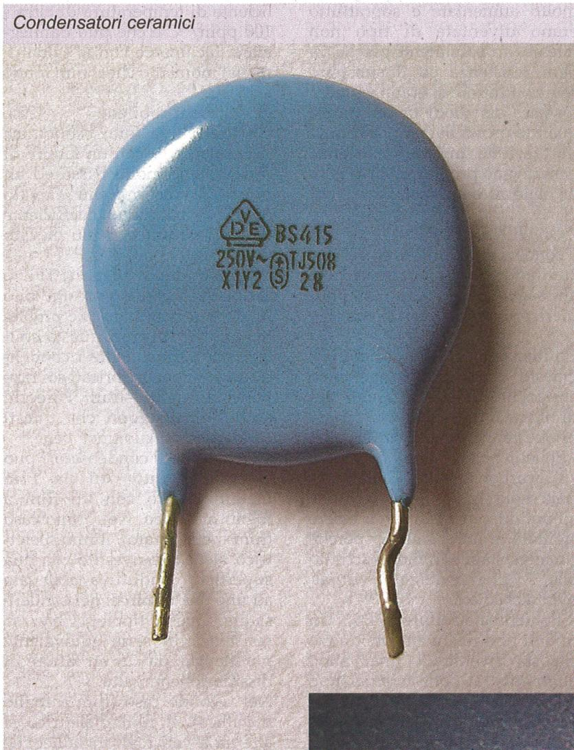
sono collegati ai terminali del condensatore. Questa tipologia ha una resistenza in serie equivalente inferiore a quella del film metallizzato.
